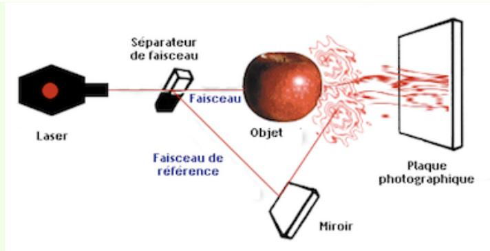
Principe de formation d'un hologramme
